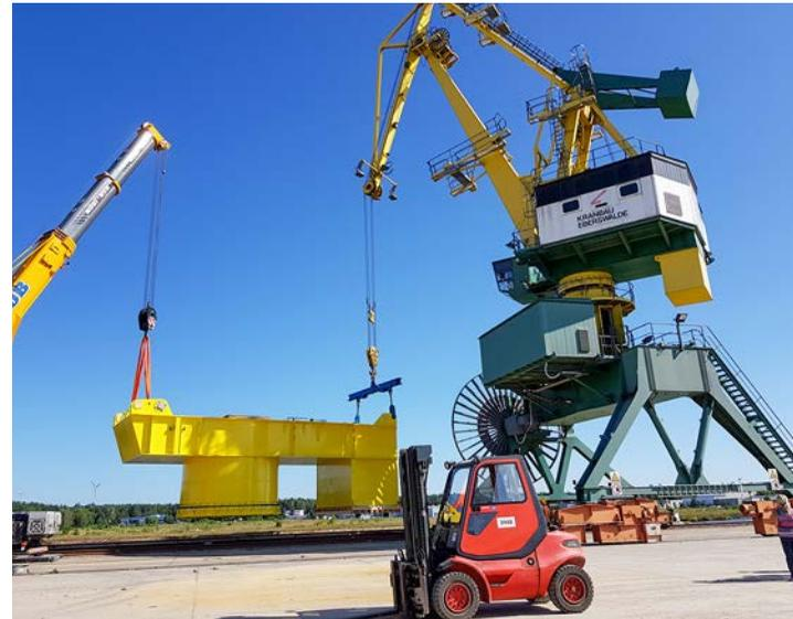
Abb. 3: Doppellenker-Hafenkran „Tukan 3000“ bei der Verladung der Maschinenhausplattform für den 125 Meter hohen MV Werft Montagekran in Wismar, Ardel-Archiv, Eberswalde
