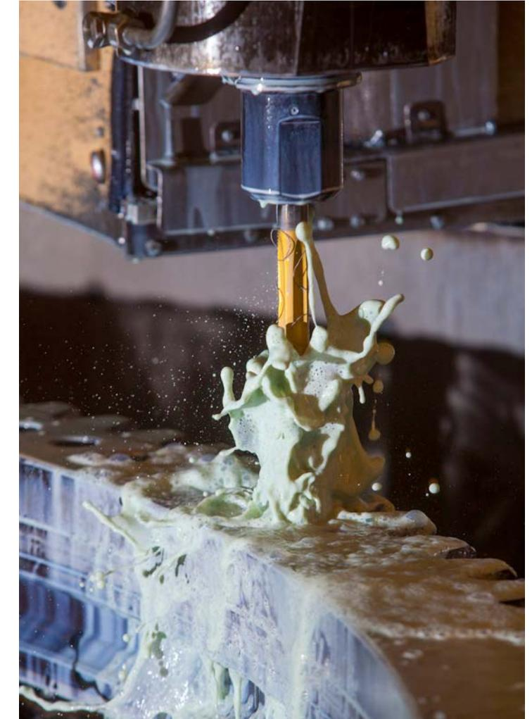
Abb. 6: Fertigen von Durchgangsbohrungen mit Titan-Nitrit beschichtetem Vollhartmetallbohrer, TKRE-Archiv, Werk Eberswalde
